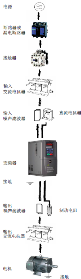
图 3-2 变频器与外围机器的连接示例
